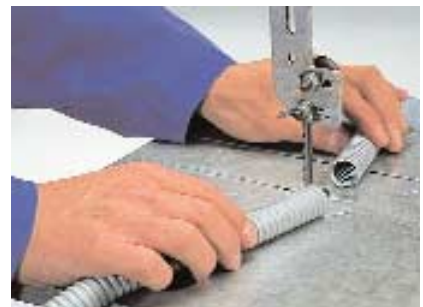
Sauberer Schnitt und gebrauchsfertige Schlauchenden Conduit ends are clean and ready for use
