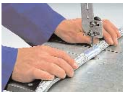
Im rechten Winkel zum Sägeblatt mit geringem Druck durchtrennen Position conduit at right angle to the band saw and carefully cut through the conduit
