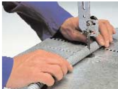
Schlauch mit wenig Druck durchsägen Cut conduit with low pressure on the conduit
