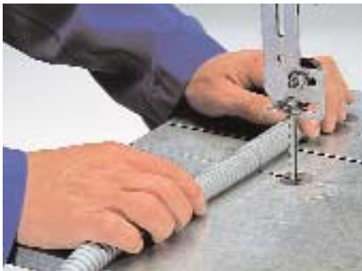
Schlauch im rechten Winkel zum Sägeblatt ansetzen Position conduit at right angles to band saw
